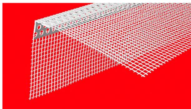
Профиль предназначен для армирования и выравнивания штукатурного слоя вертикальных и горизонтальных внешних и внутренних угловых зон на фасадах зданий, в т.ч. при монтаже системы теплоизоляции штукатурного типа (СФТК).
